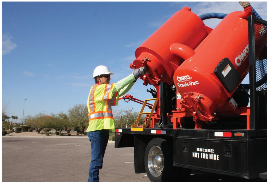
空气质量对我们来说是最重要的关注点。科来福裂缝真空除尘设备在清理道路裂缝的同时始终保持工作场所和公众环境清洁、安全的状态。裂缝真空除尘设备的悬臂可以伸展越过卡车车顶从而让操作工作处于车辆前端避免在操作时远离其他正常开放交通的车道。配置了低至10微米（PM10）级别的颗粒过滤系统使得科来福裂缝真空除尘设备符合现阶段已实施的最严苛空气质量标准规定。
