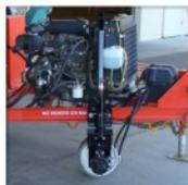
动力驱动轮机构(可选项)提高了施工灵活性，施工现场不需要拖车
