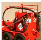
电加热输胶软管安全低电压电加热输胶软管可以配合燃烧器工作将密封胶的熔融状态保持到输胶管出口的最前端，科来福的输胶软管可以360度旋转，在同类型产品中工作半径最大。
