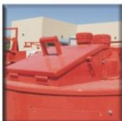
搅拌器自动开关和防溅盖板加料口盖板防溅设计有效防范烫伤风险，高强度铰链降安装为降低加料时的工作强度提供了保证；自带的安全开关和搅拌器互锁，打开盖板时，搅拌器自动停止搅拌提高了安全性。
