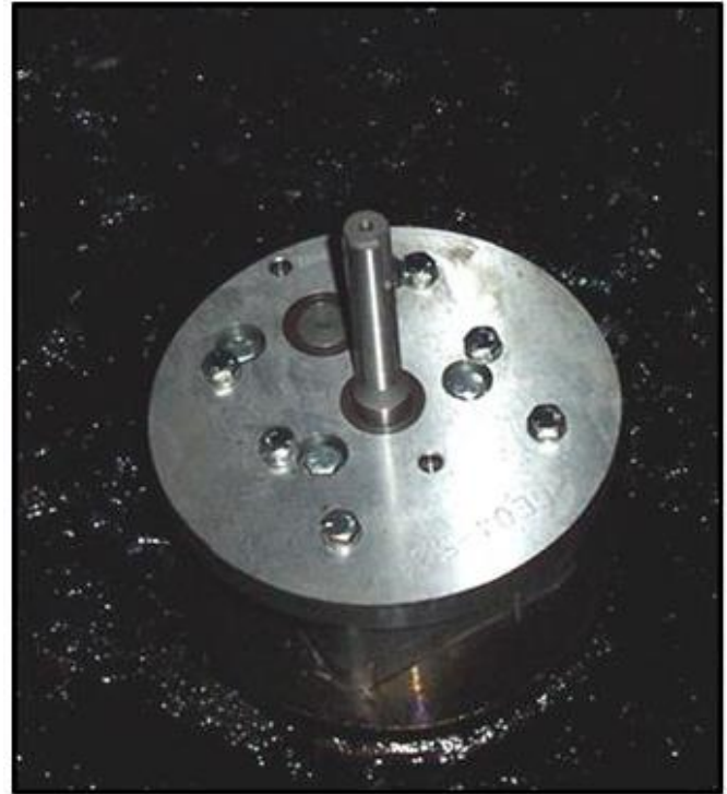
图 6.9 安装新的材料泵
