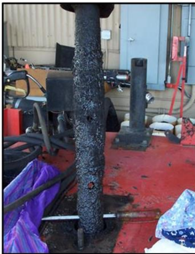
图 6.5 从材料泵远离分开后的搅拌器的支撑
