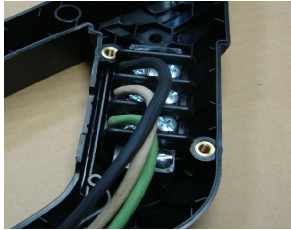
图 6.17 接线端子块接线
