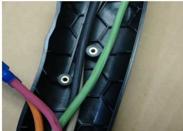
图 6.16 扳机开关线的布线
