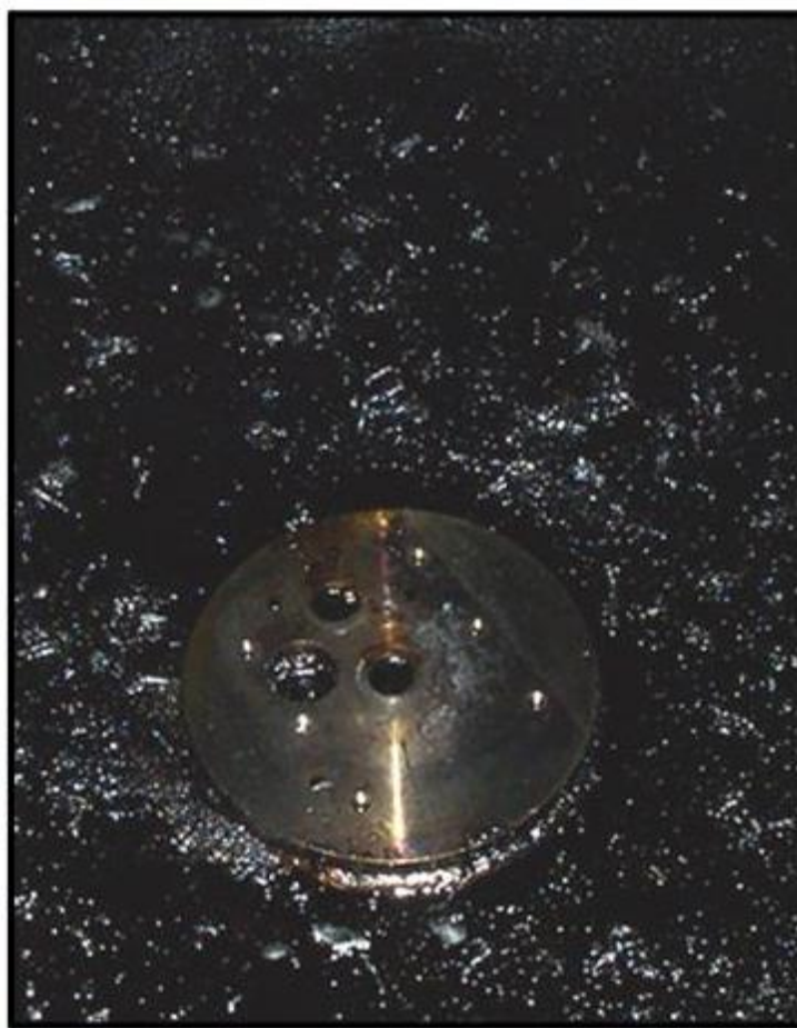
图 6.7 材料泵安装板的清洁
