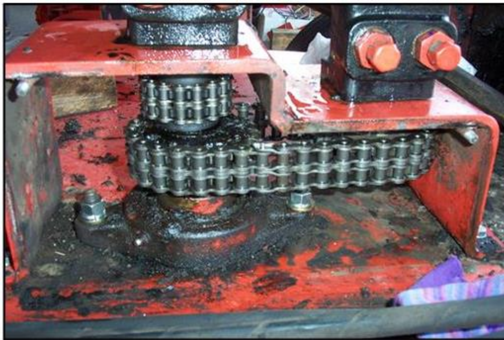
图 6.14 搅拌器链条张紧步骤
