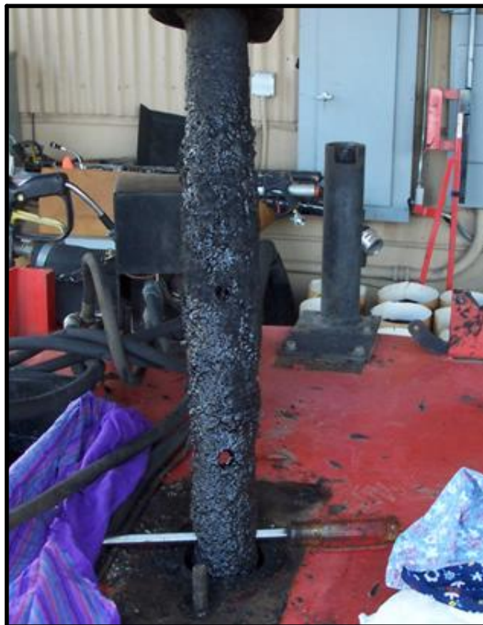
Fig. 6-5 Sujetando el Agitador al Separarlo de la Bomba de Material
