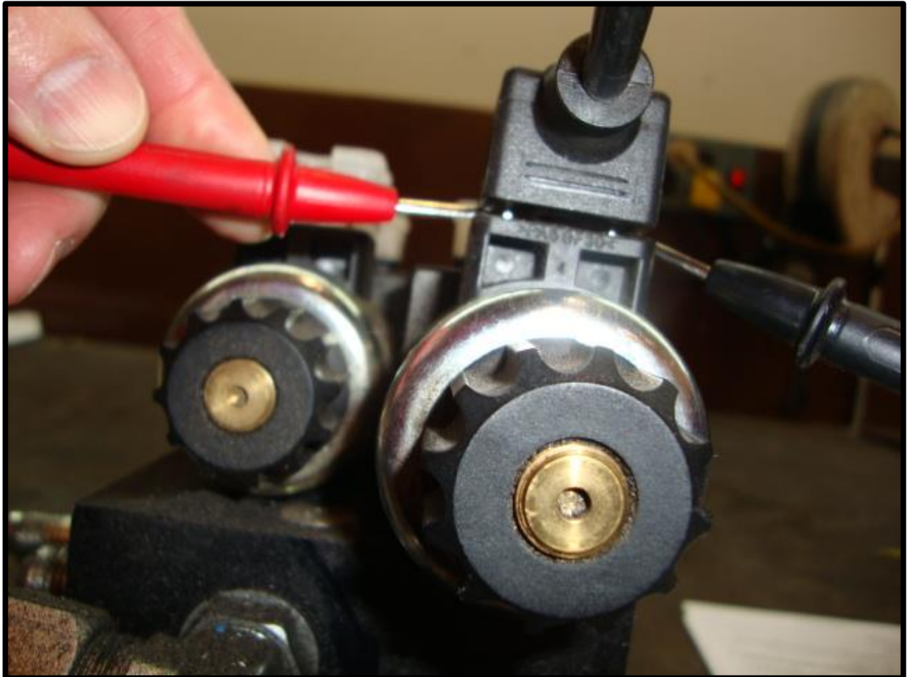
Fig. 8-4 Verificar el Voltaje del Conector Din
