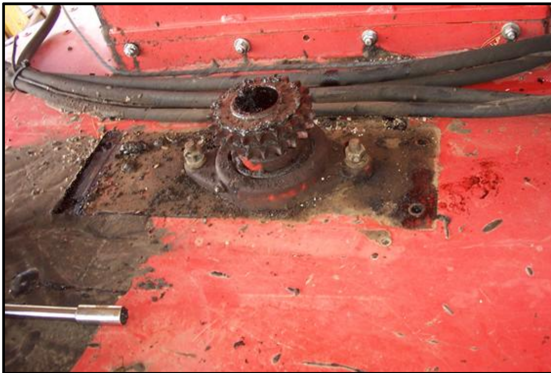
Fig. 6-4 Retirar el Ensemble de la Montura del Motor
