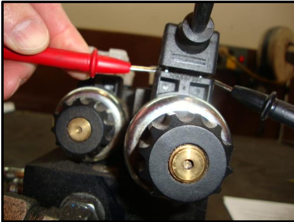
Figure 8-4 Checking Din Plug Voltage
