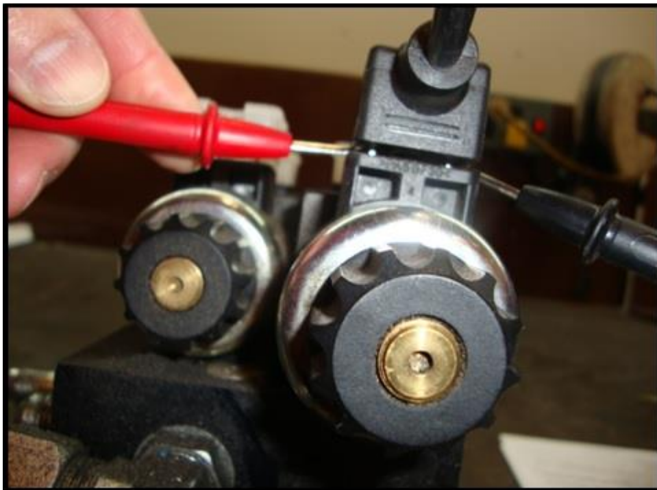
Figure 8-4 Checking Din Plug Voltage
