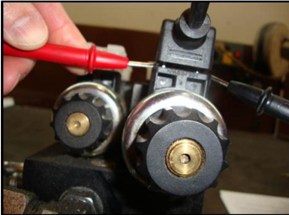
Figure 8-4 Checking Din Plug Voltage
