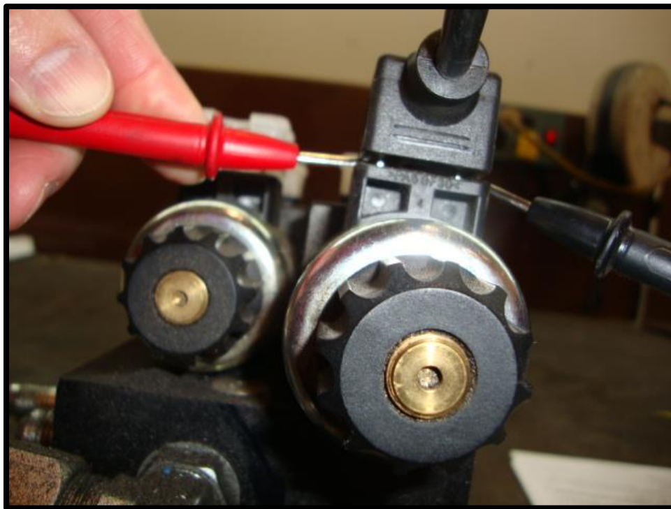
Figure 8.4 Checking Din Plug Voltage
