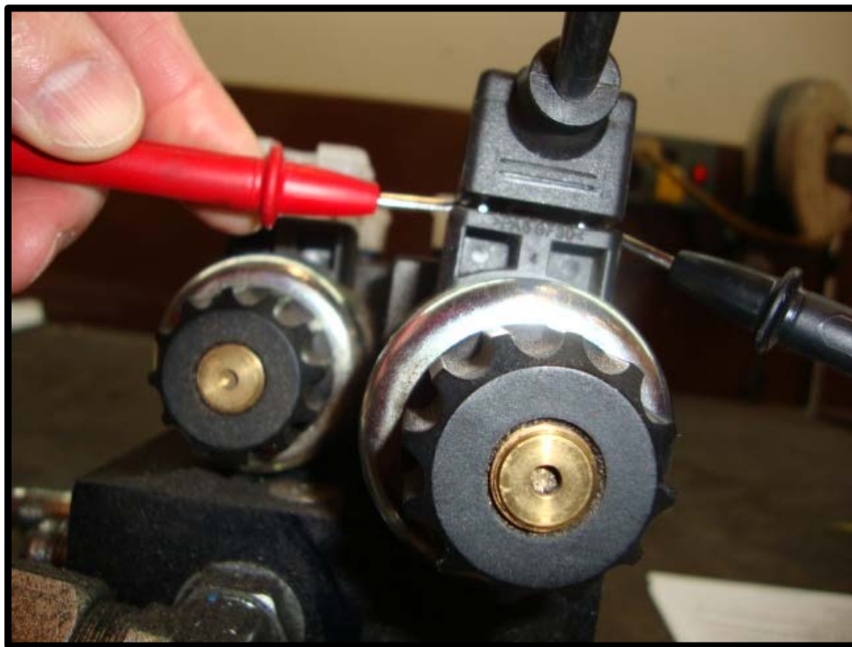
Figure 8.4 Checking Din Plug Voltage
