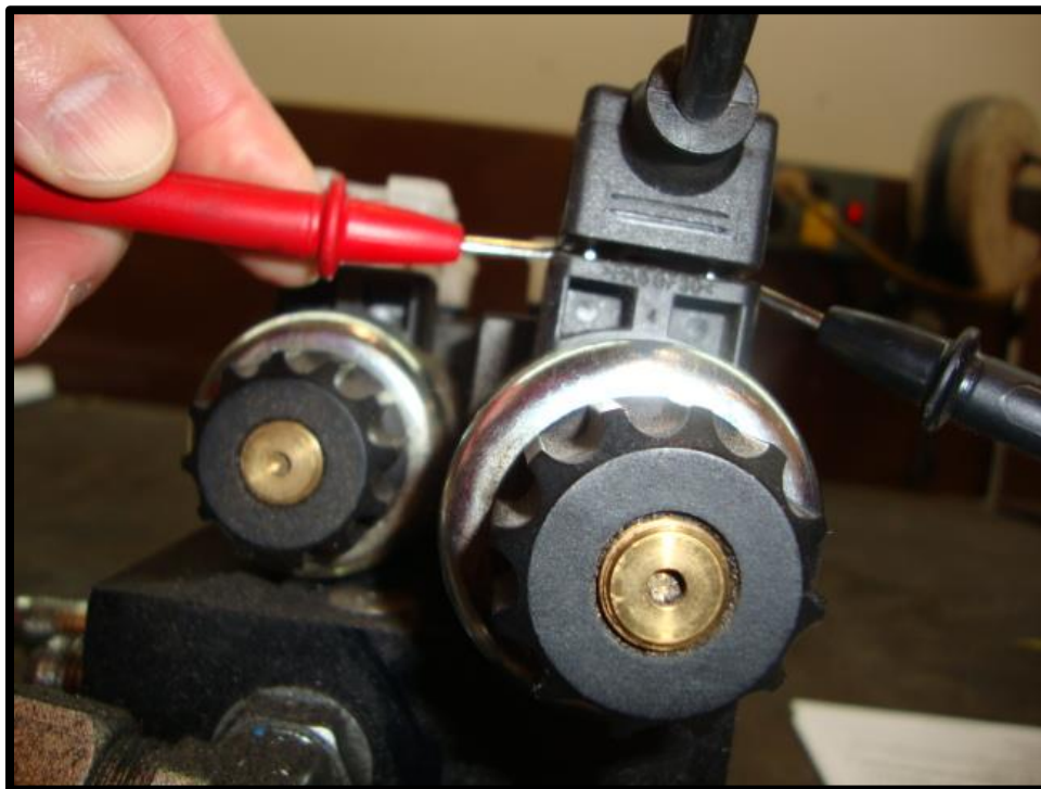
Figure 8-4 Checking Din Plug Voltage
