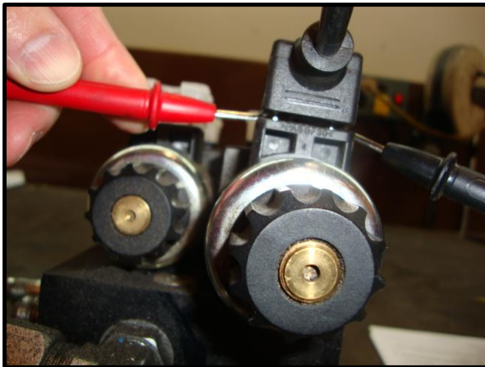
Figure 8-4 Checking Din Plug Voltage
