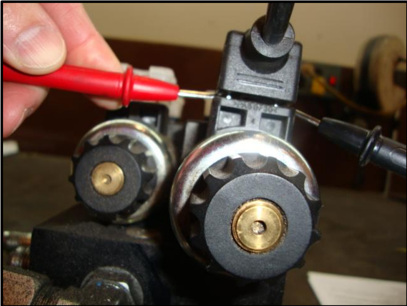
Fig. 8-4 Checking Din Plug Voltage
