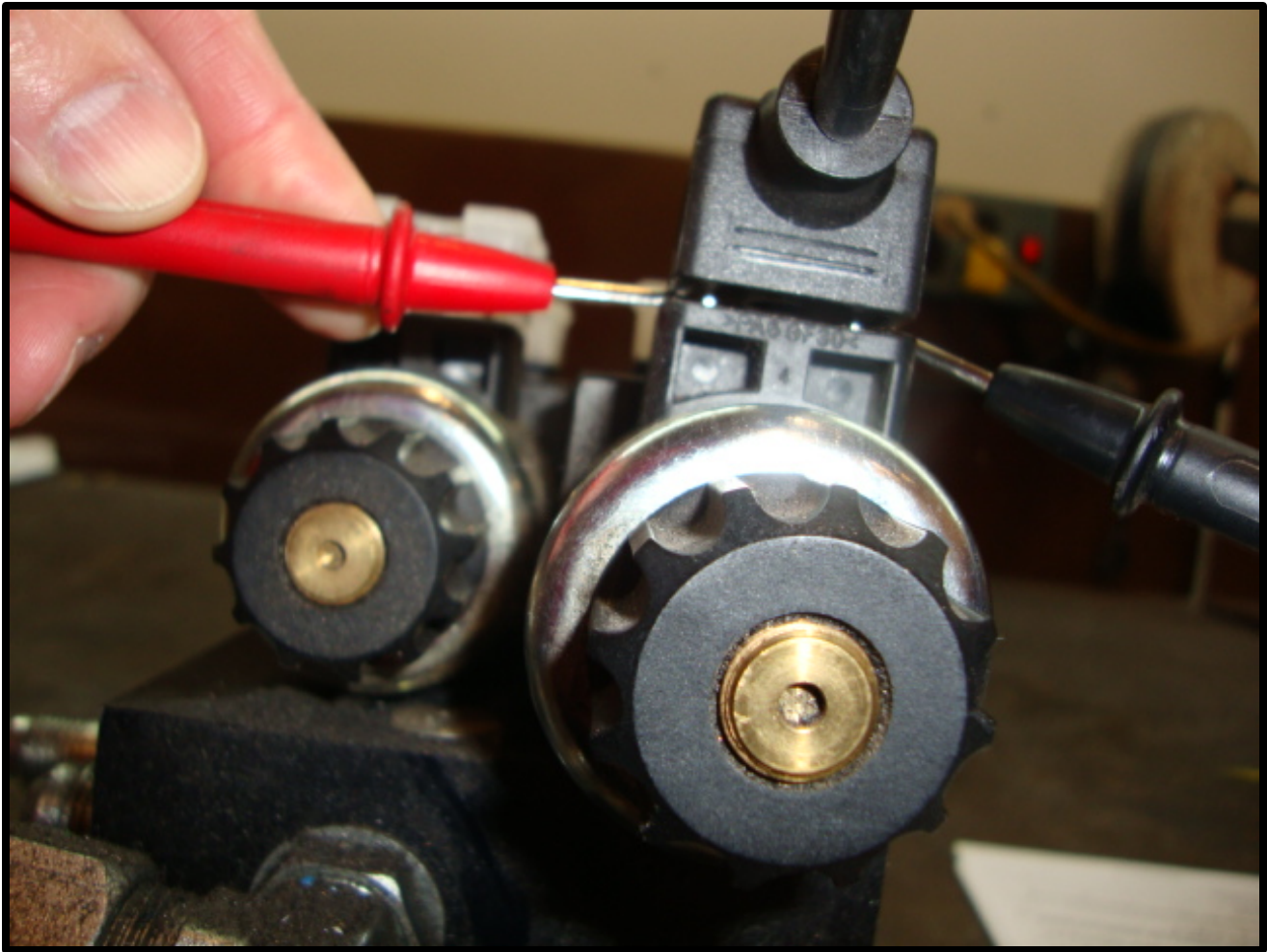
Fig. 8.5 Checking Din Plug Voltage
