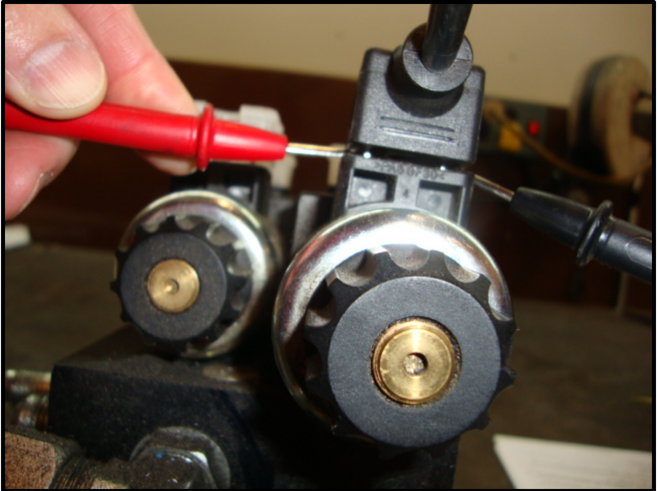
Fig. 8-6 Checking Din Plug Voltage
