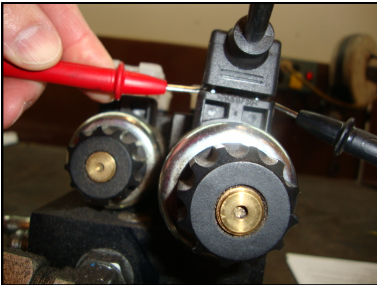
Fig. 8.4 Checking Din Plug Voltage
