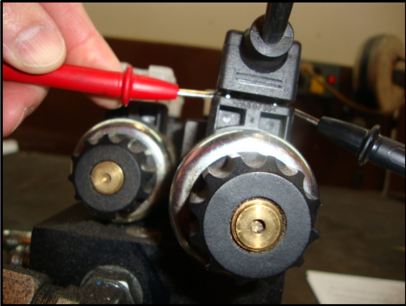
Fig. 8.4 Checking Din Plug Voltage
