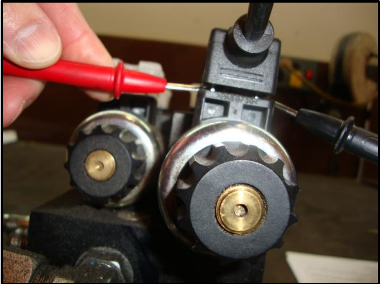
Fig. 8-4 Checking Din Plug Voltage
