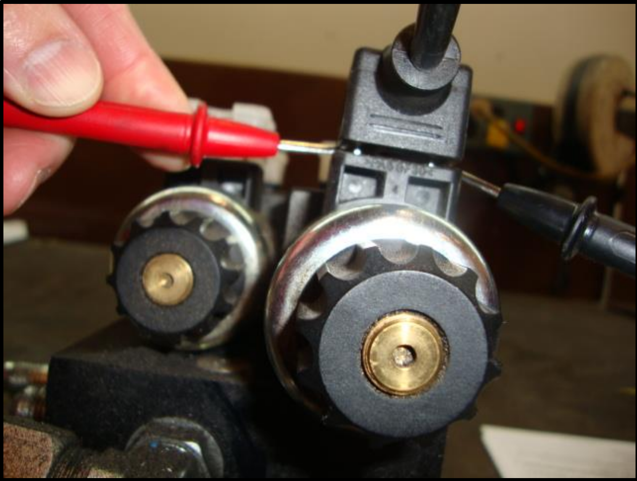
Fig. 8-4 Checking Din Plug Voltage
