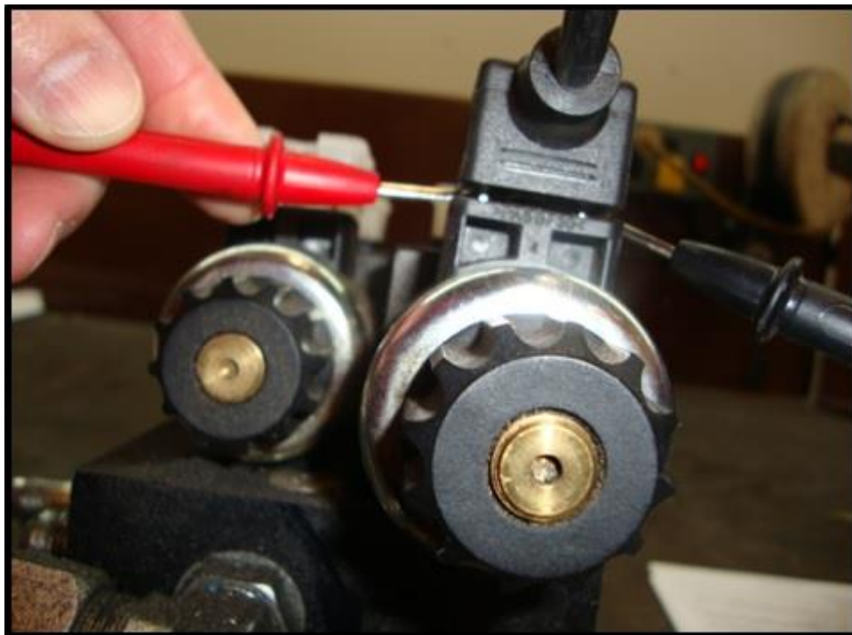
Figure 8-4 Checking Din Plug Voltage
