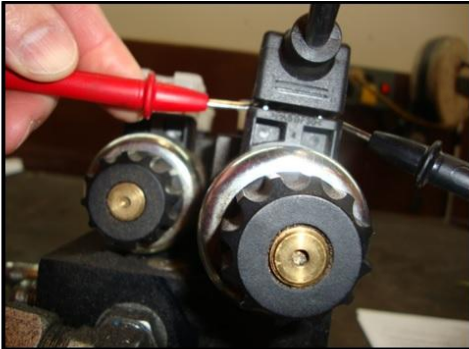
Figure 8-4 Checking Din Plug Voltage
