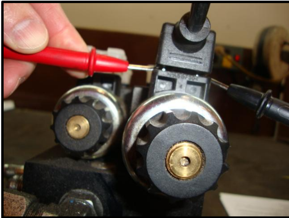
Figure 8-4 Checking Din Plug Voltage
