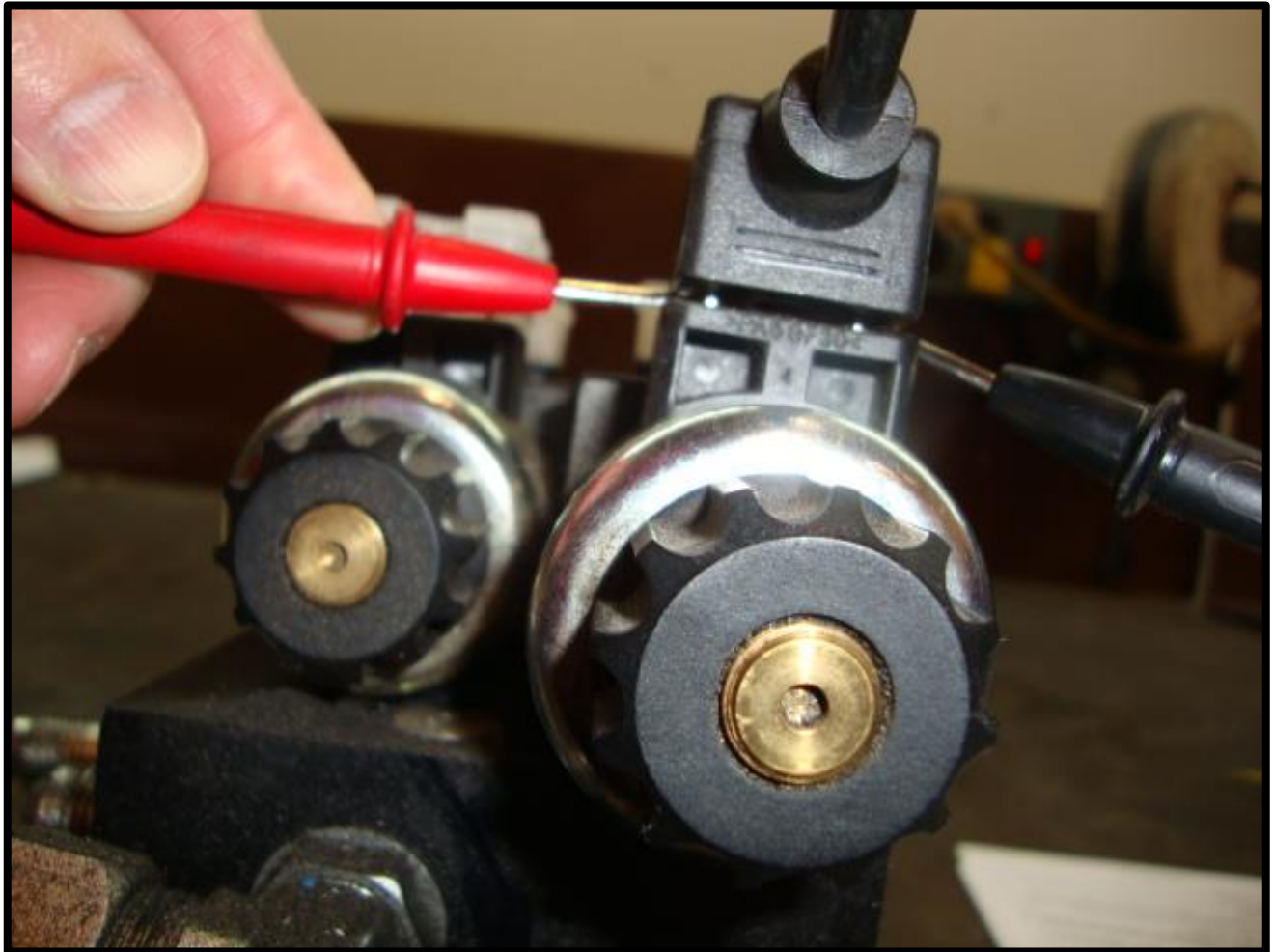
Fig. 8-4 Checking Din Plug Voltage
