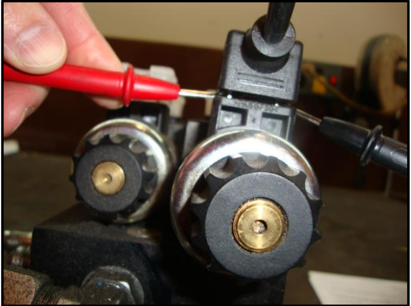
Fig. 8-4 Checking Din Plug Voltage
