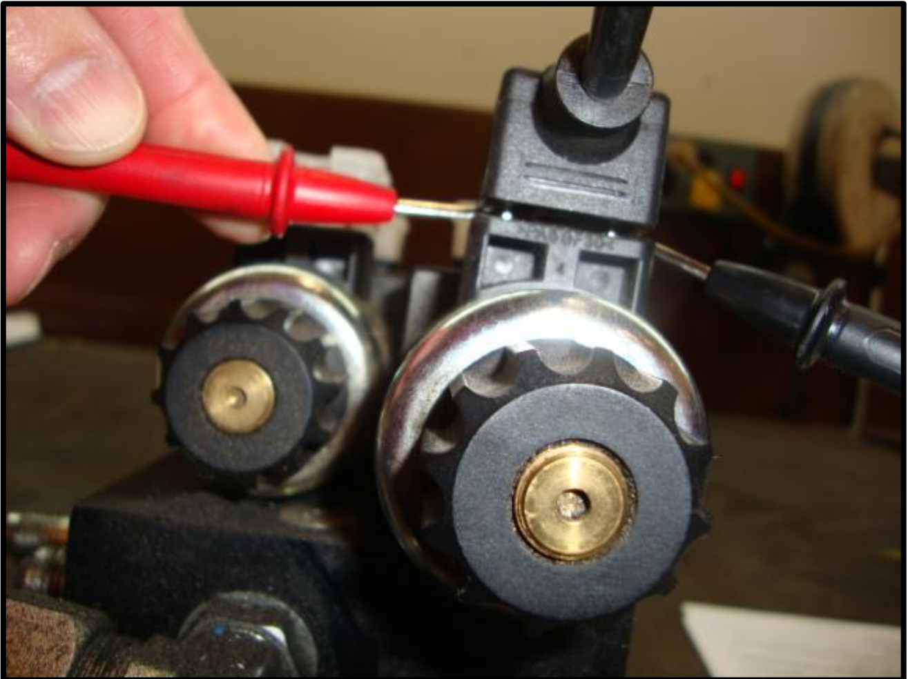
Fig. 8-4 Checking Din Plug Voltage
