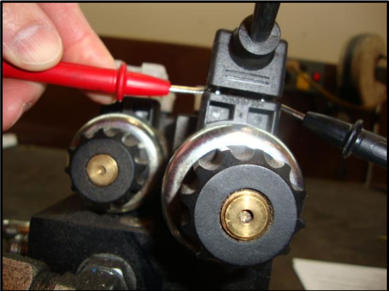
Fig. 8-4 Checking Din Plug Voltage
