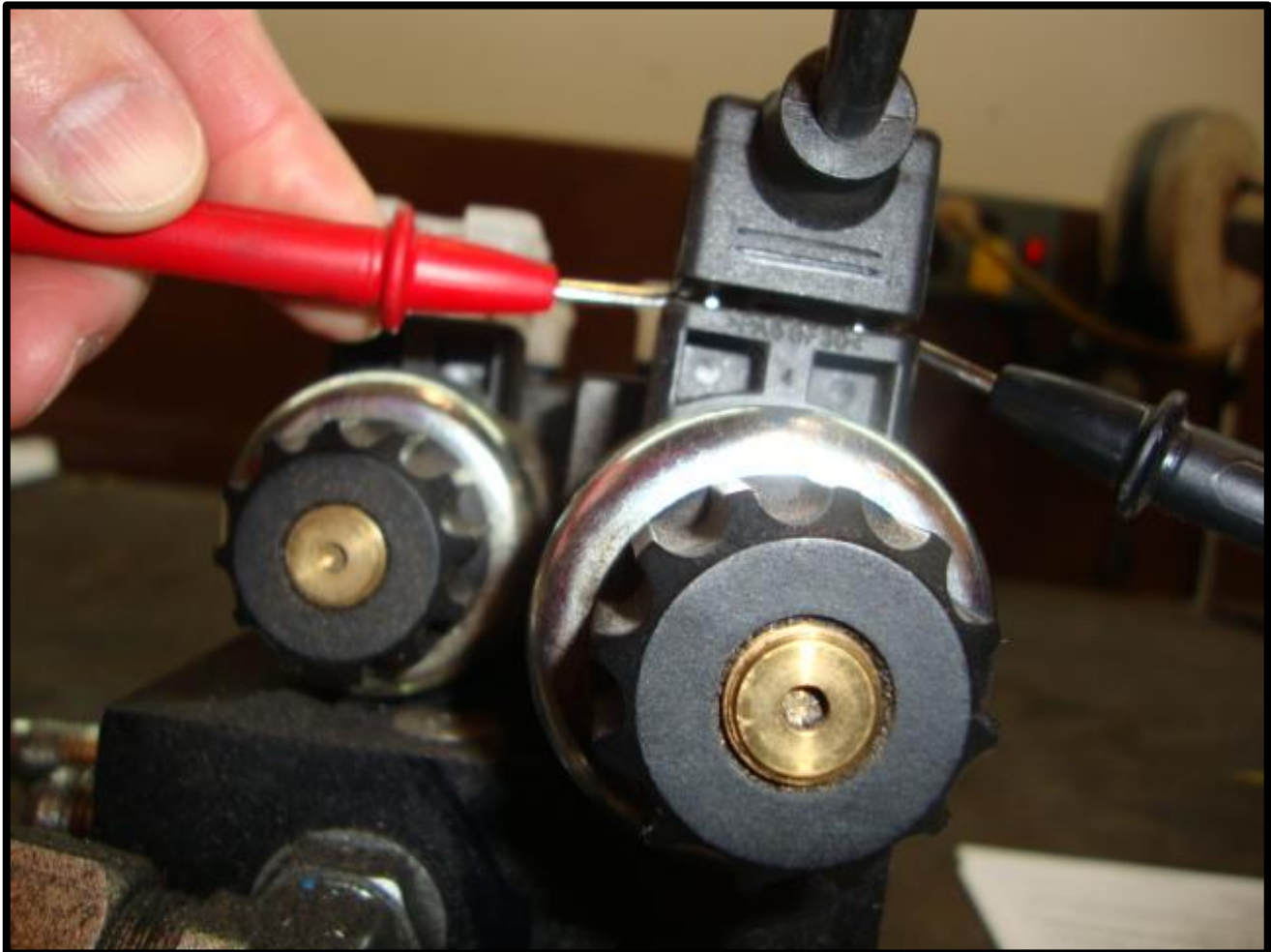
Fig. 8-4 Checking Din Plug Voltage
