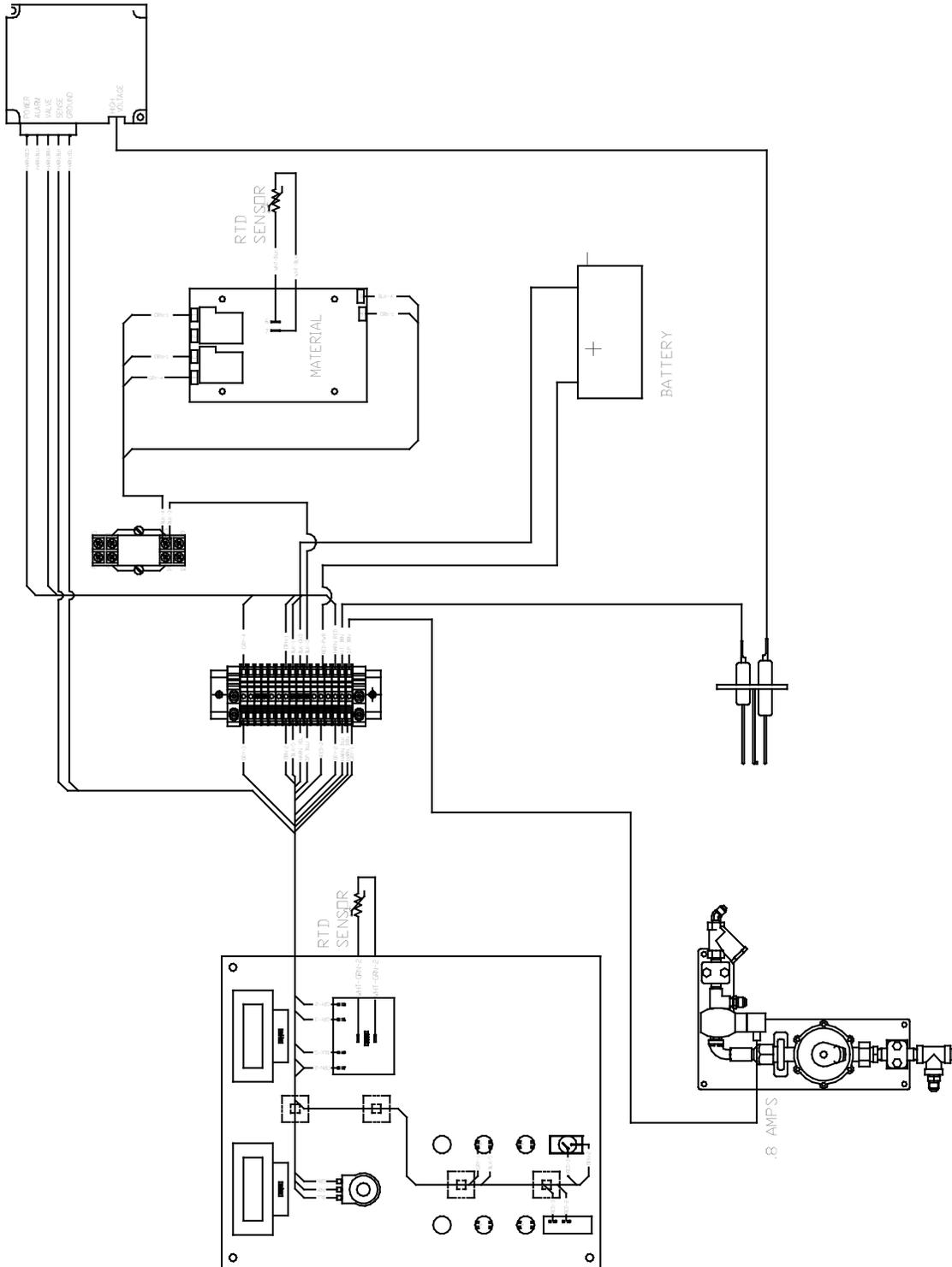
**SS60 LPG BURNER SCHEMATIC**
