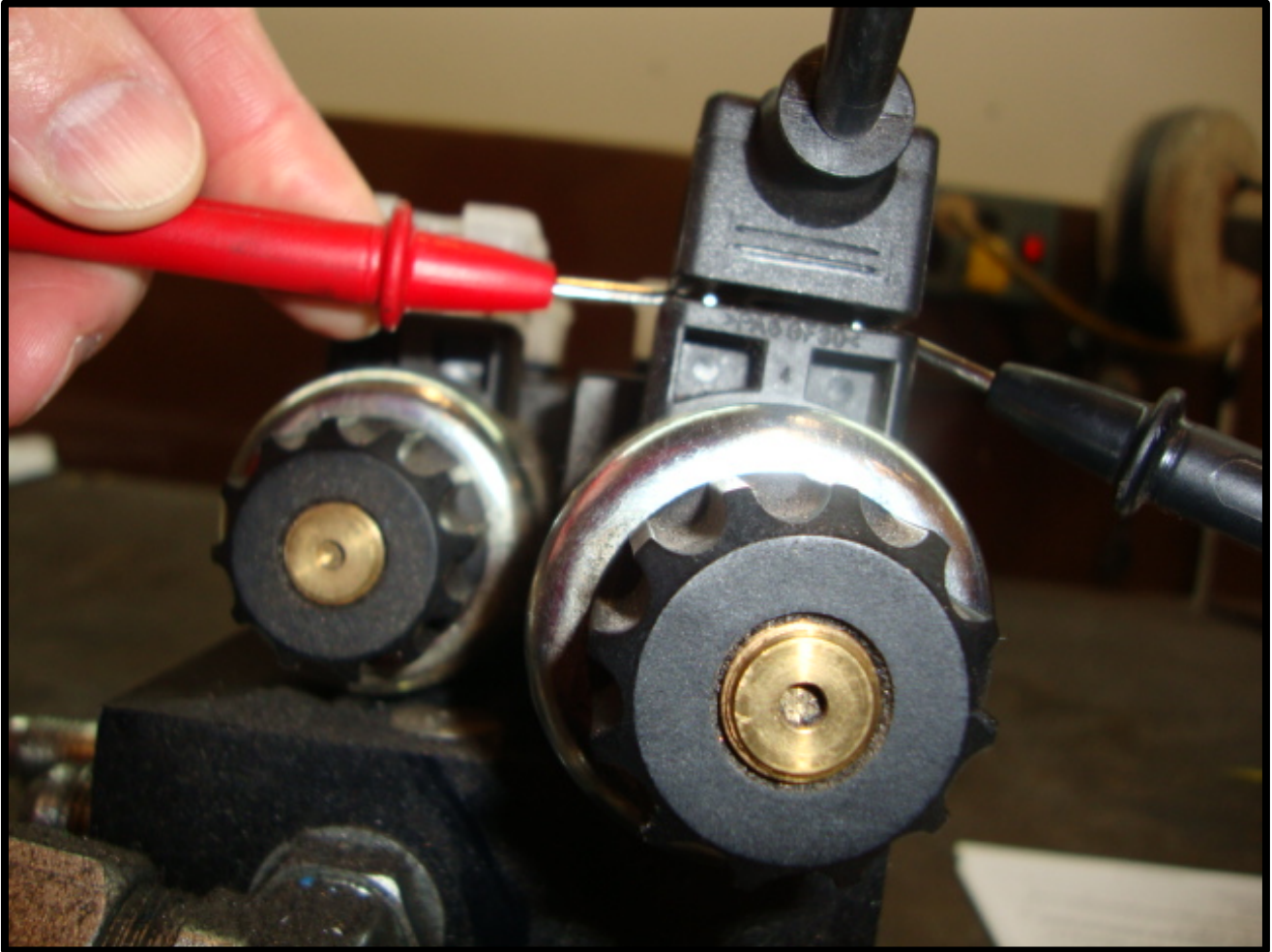
Figure 8.4 Checking Din Plug Voltage
