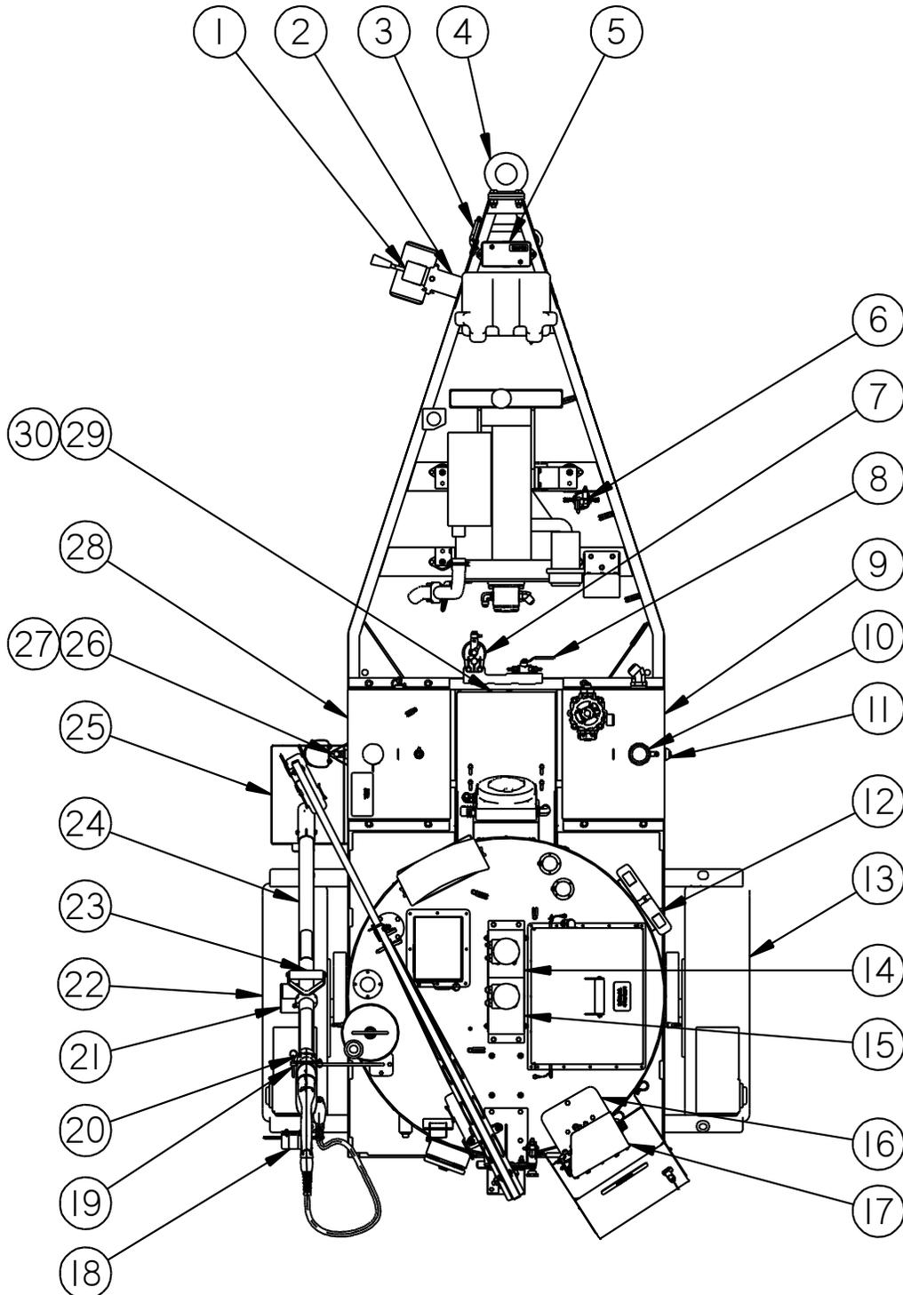
**Fig. 9-1 Super Shot 60 Diesel Melter: PN 58700N**
