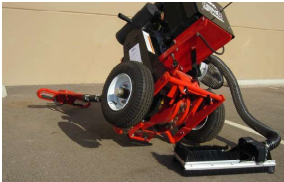
Figura 5-1 Ruteadora Modelo 30 Elevado para la Instalación de la Cubierta de Polvo
